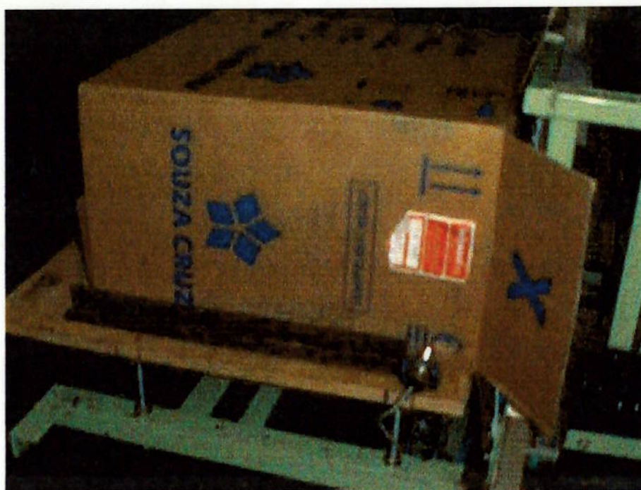
figura 5.3.6 Sensor capacitivo para a detecção da presença da caixa de papelão
