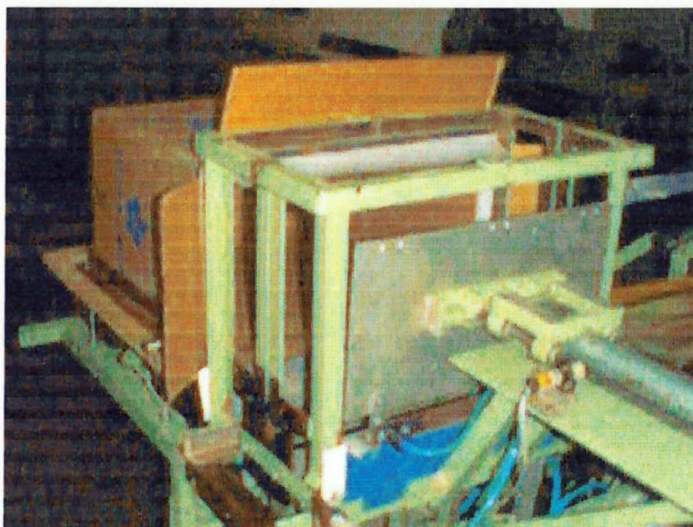
figura 5.2.4.4 Disposição da caixa de papelão relativa a atuação do pistão Empurrador
