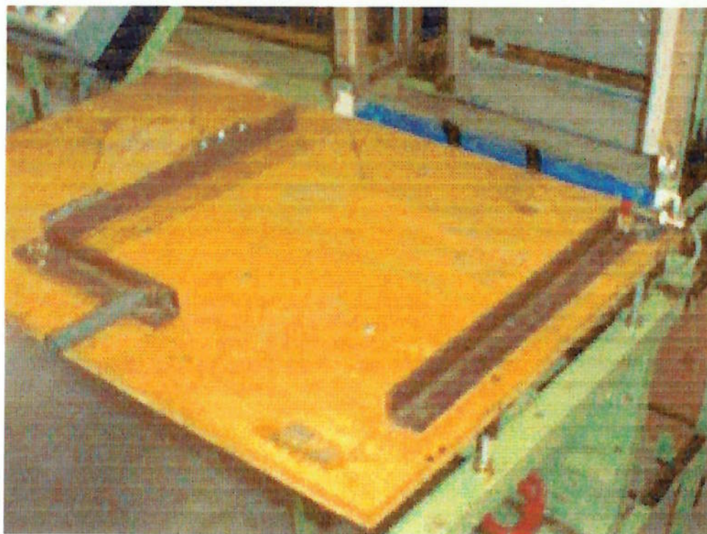
figura 5.2.4.1 Dispositivo de encaixe da caixa de papelão (I)
