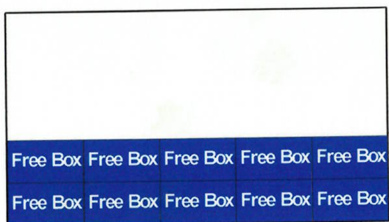
figura 1.2.2 Inserção das 2 primeiras fileiras de pacotes na caixa de papelão
