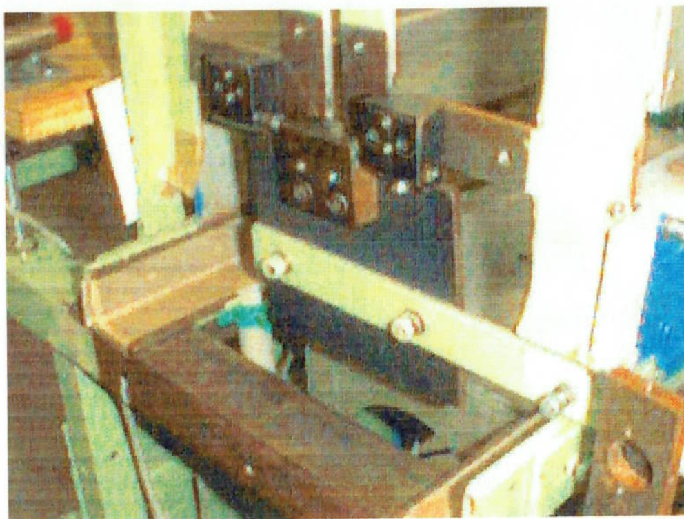
figura 5.2.6.1 Mecanismo de abertura para retirada de pacotes encalhados (I)
