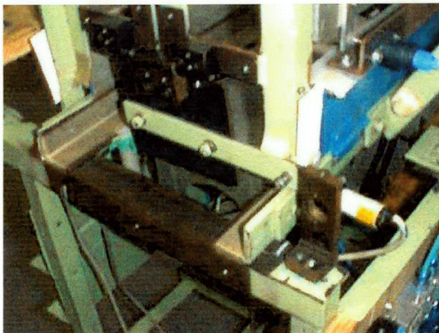
figura 5.3.5 Sensor indutivo responsável pela detecção da posição da portinhola
