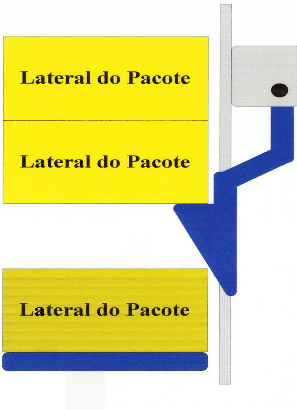
figura 3.2.2.1.1 Fileira de pacotes prestes a ser inserida no acumulador (visão da aleta
