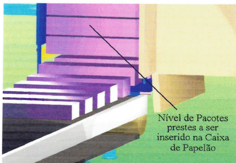
figura 4.1.1.4 Pacotes prestes a serem inseridos na caixa (avanço de P2)
