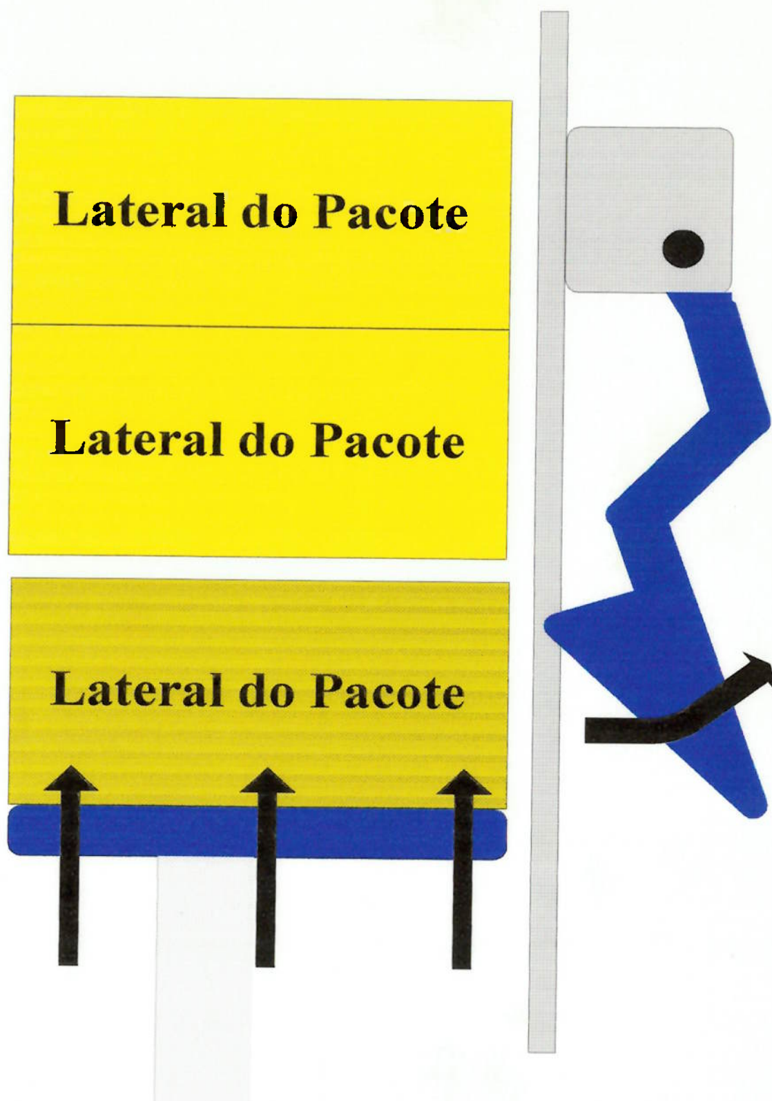
figura 3.2.2.1.2 Fileira de pacotes sendo inserida no acumulador (visão da aleta 1)
