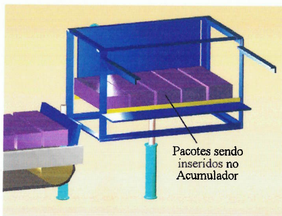
figura 4.1.1.2 Pacotes na Fileira de Inserção sendo elevados para o Acumulador
