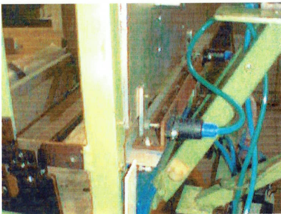
figura 5.2.5.1 Pistão e acoplamento da tira acrílica
