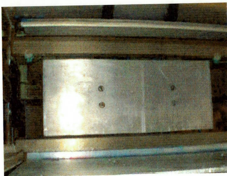
figura 5.4.1 Sensores indutivos na base da Fileira de Inserção (vista superior)
